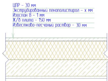
Рисунок 1.4 – Устройство чердачного перекрытия
