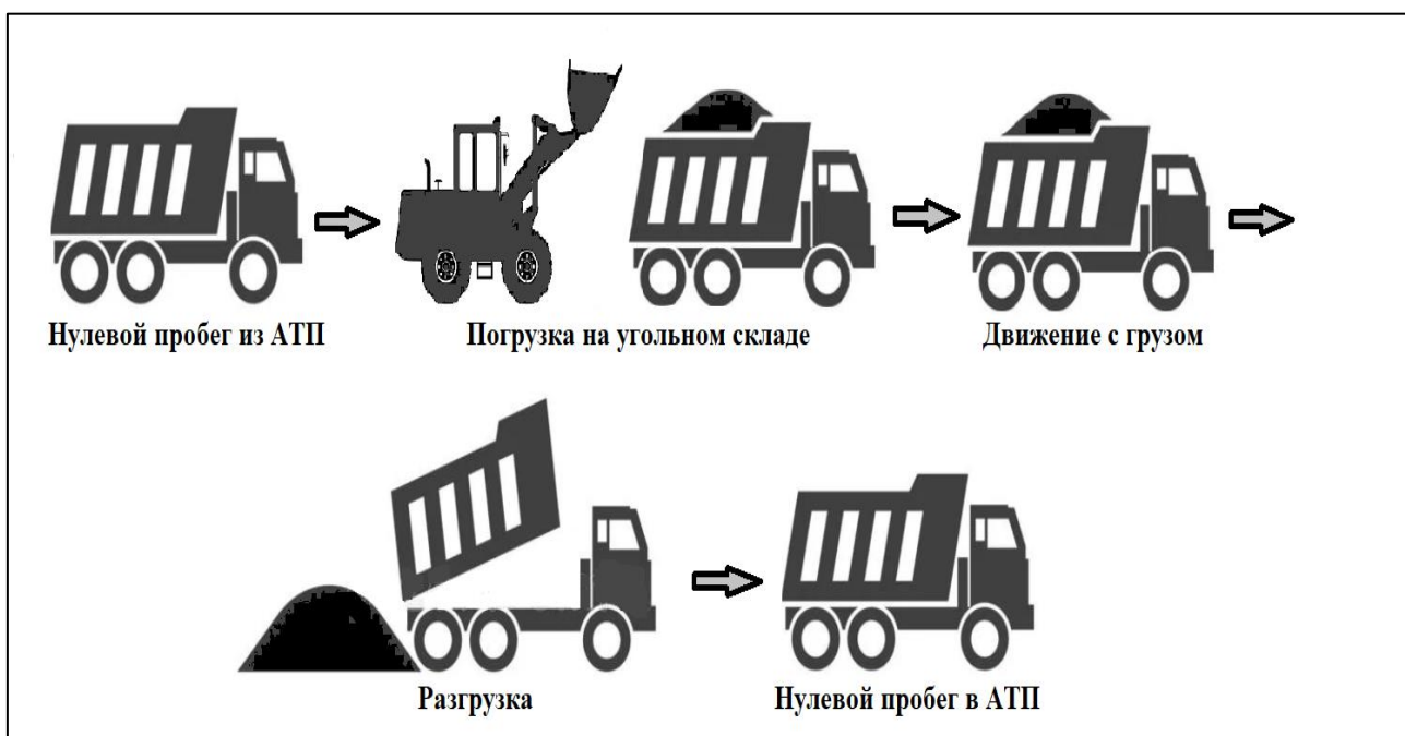
Рисунок 1.22 — Общая схема доставки угля
