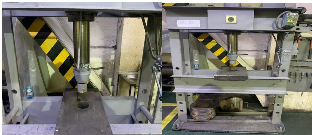
Рисунок 3.6 - Пресс для распрессовки пресс-форм.
