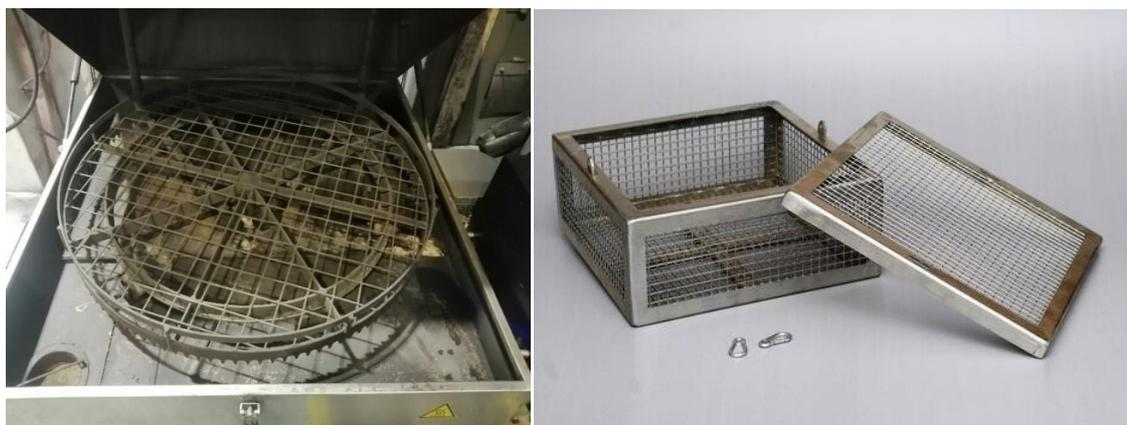
Рисунок 3.2 - Корзина для мойки мелких деталей.
