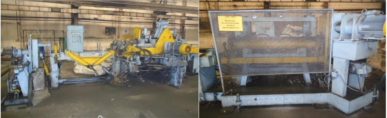
Рисунок 3.8 - Защитный экран для установки изготовления штанг анододержателей
