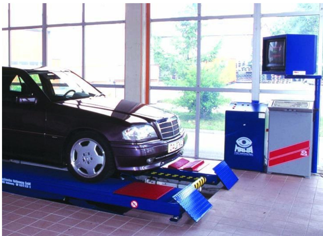
Рисунок 3.1 – Стенды контроля состояния подвески и рулевого управления PMS для легковых автомобилей с максимальной нагрузкой на ось 3,5
