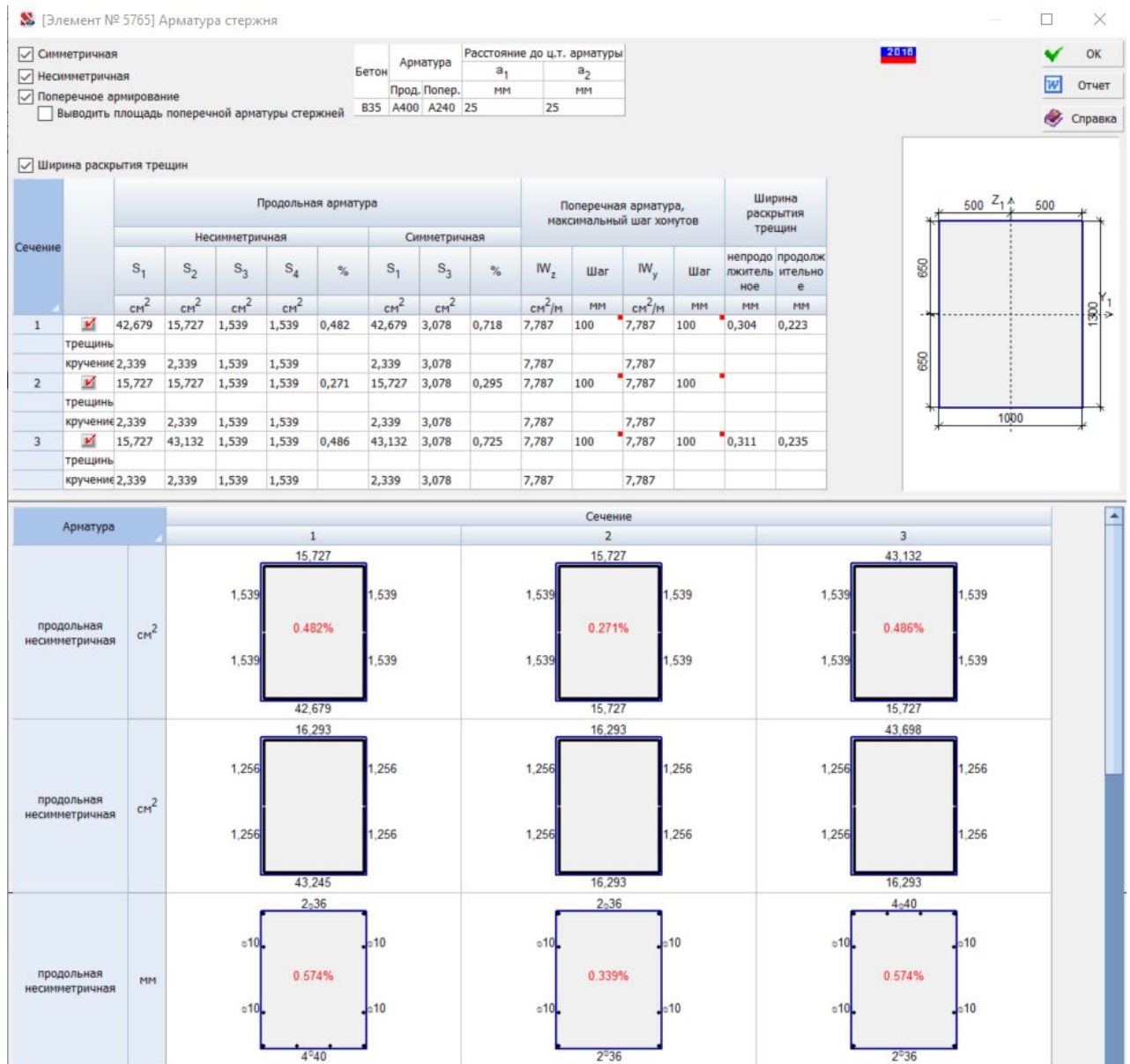
Рисунок 3.46 – Результаты подбора арматуры в ПК SCAD для МП на опоре
