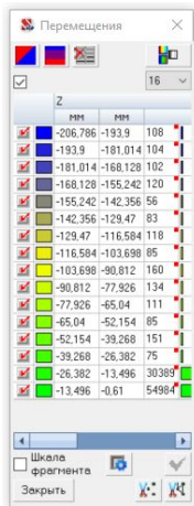
Рисунок 3.17 – Перемещения при самом неблагоприятном сочетании нагрузок по оси Z, мм
