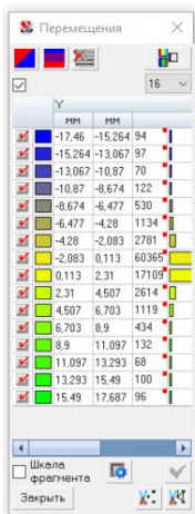
Рисунок 3.16 – Горизонтальные перемещения при самом неблагоприятном сочетании нагрузок по оси Y, мм
