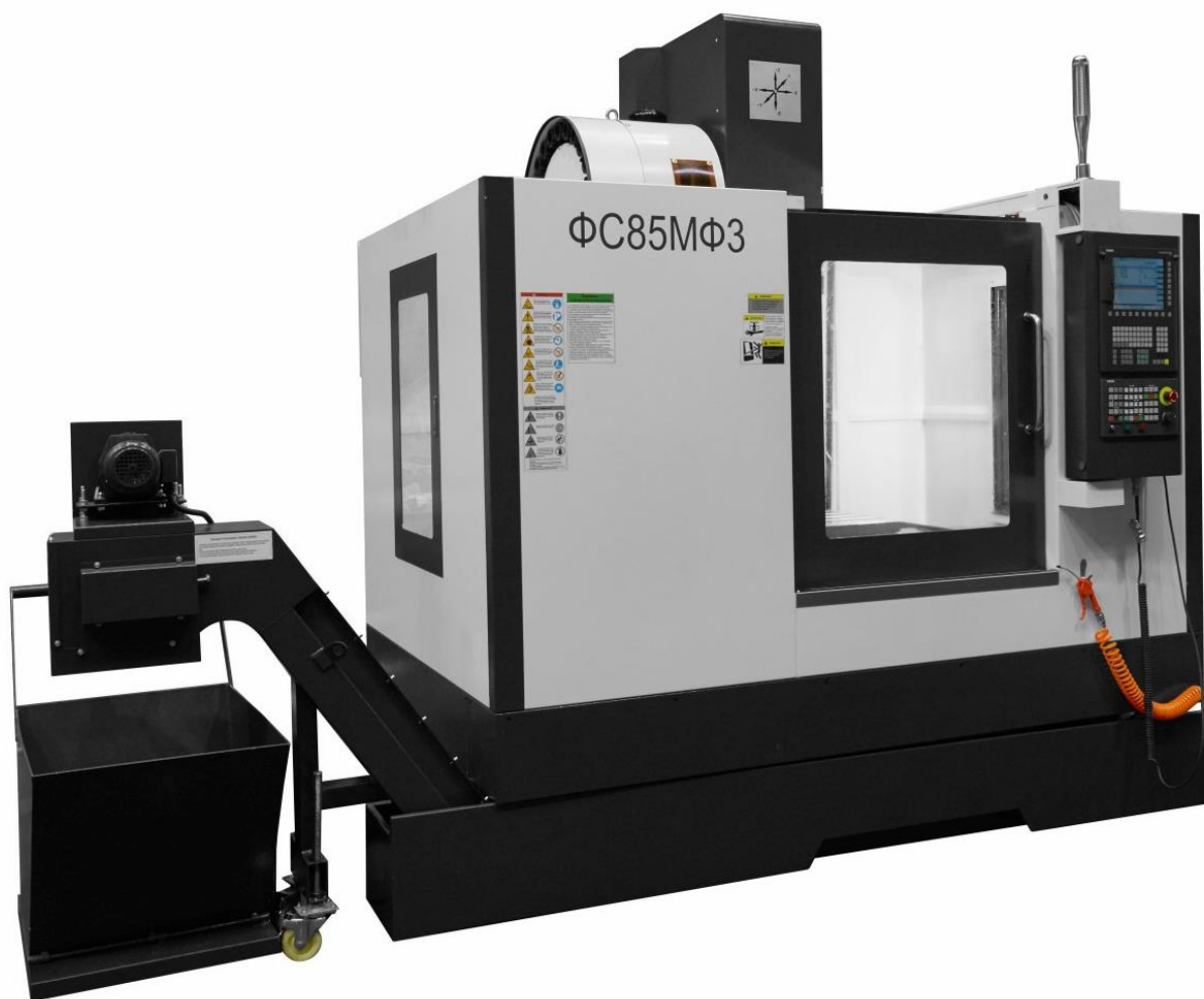
Рисунок 2 – Вертикальный обрабатывающий центр ФС85МФ3
