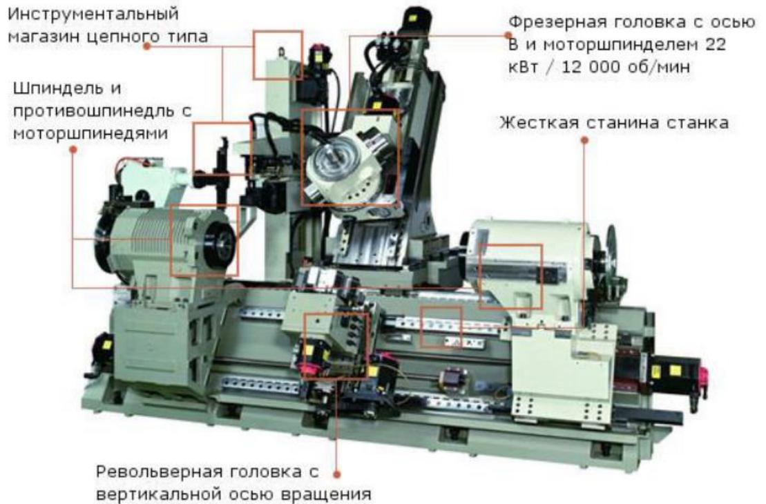
Рисунок 1.3 – Структура токарно-фрезерного обрабатывающего центра Victor Vturn-X200
