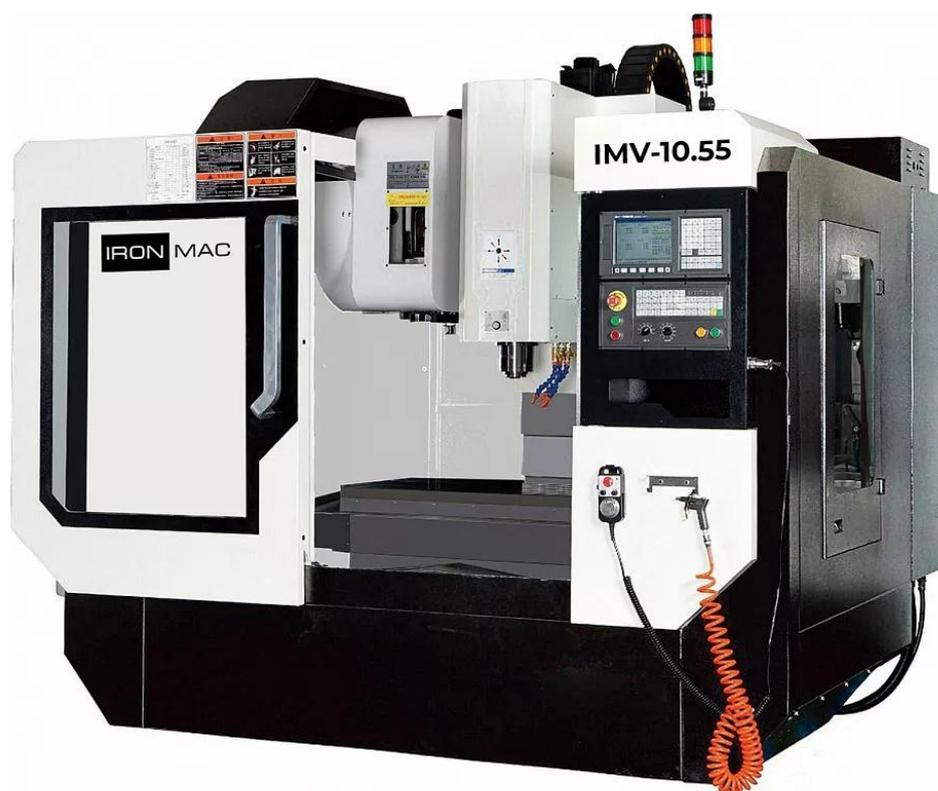
Рисунок 1 – Вертикальный обрабатывающий центр IRONMAC IMV-10.55
