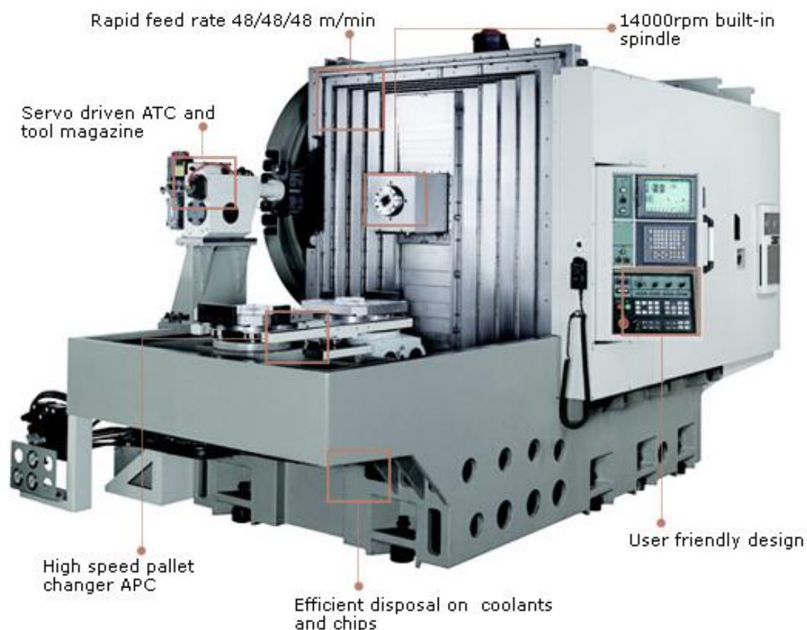
Рисунок 1.4 – Основные элементы станка
