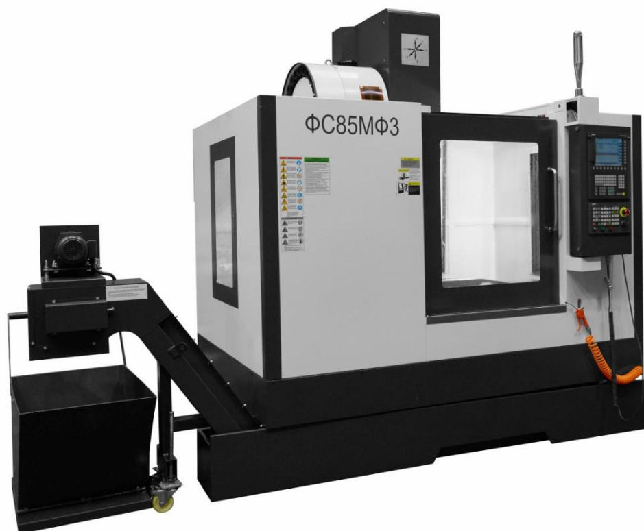
Рисунок 1 – Вертикальный обрабатывающий центр ФС85МФ3
