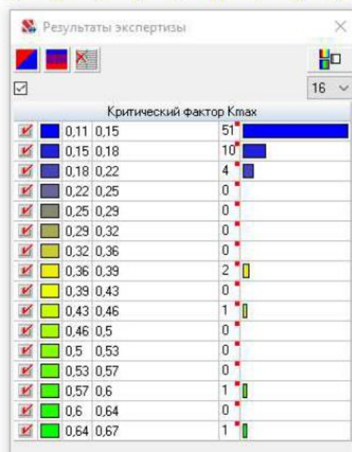
Рисунок 3.34 – Коэффициенты использования сечения (стойки фермы рамы)
