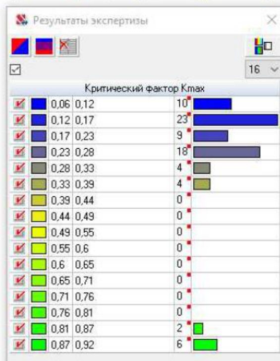
Рисунок 3.35 – Коэффициенты использования сечения (раскосы фермы рамы)
