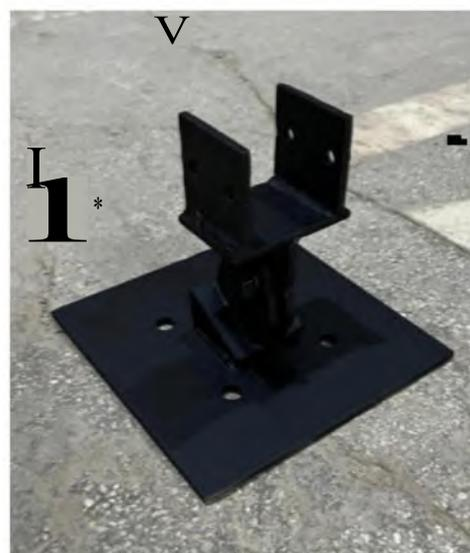
Рисунок 100 - Схема опорного шарнира и изготовленная конструкция
