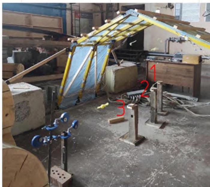
Рисунок 124 - Схема прогибомеров модели
