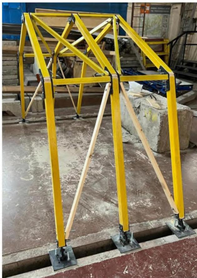
Рисунок 106 – Крепление вертикальных связей конструкции
