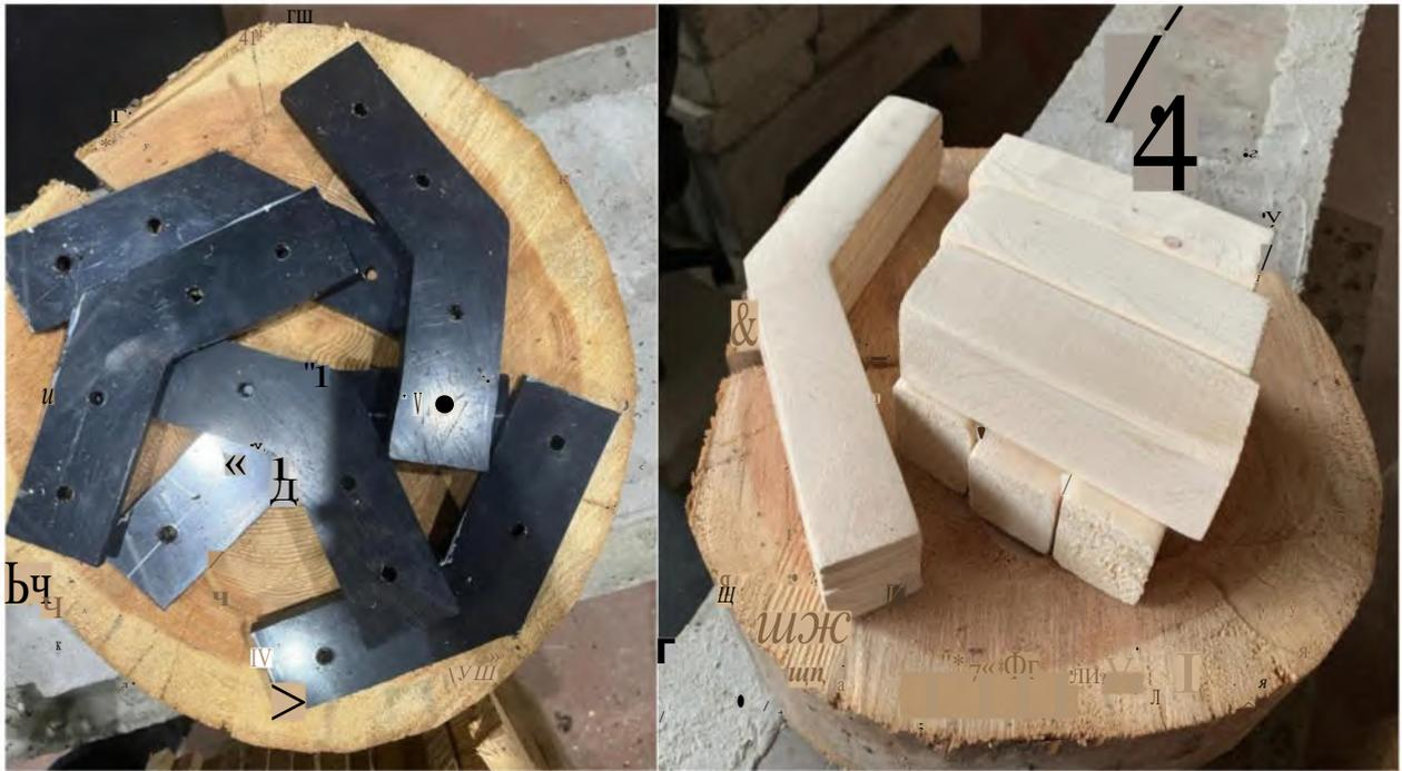
Рисунок 104 - Пластиковые накладки и деревянные бруски-вставки
