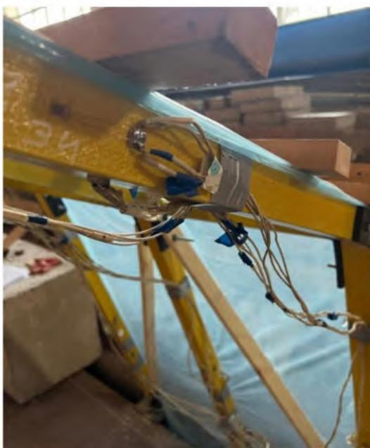
Рисунок 111 – Тензометрический датчик на конструкции
