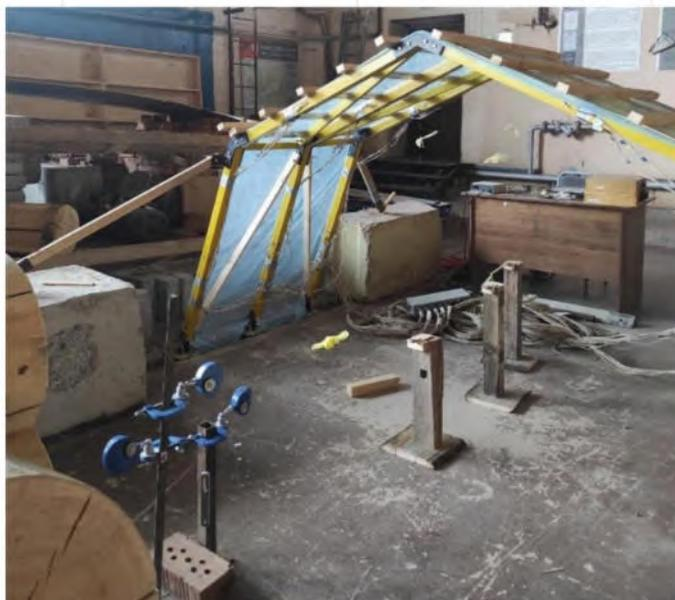
Рисунок 115 – Схема прогибомеров бПАО-ЛИСИ (ПГВ)
