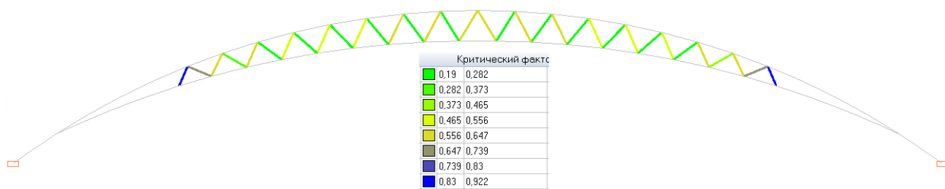
Рисунок 1.9 – Подбор сечения раскосов арки (вариант 2.3)
