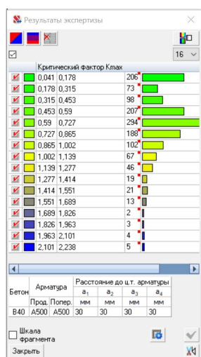
Рисунок 3.26 – Результаты экспертизы нижнего армирования плиты перекрытия
