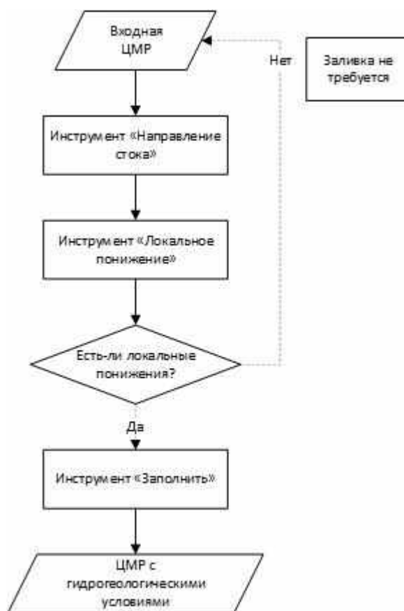
Рисунок 8 – Блок-схема создания модели рельефа с гидрологическими условиями
