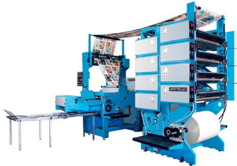
Рисунок 1.2 Печатная рулонная офсетная газетная машина «Фактор-90»
