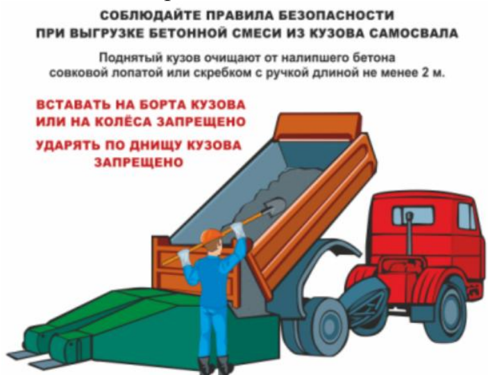
Рисунок 5.2 – Безопасность при выгрузке бетонной смеси
