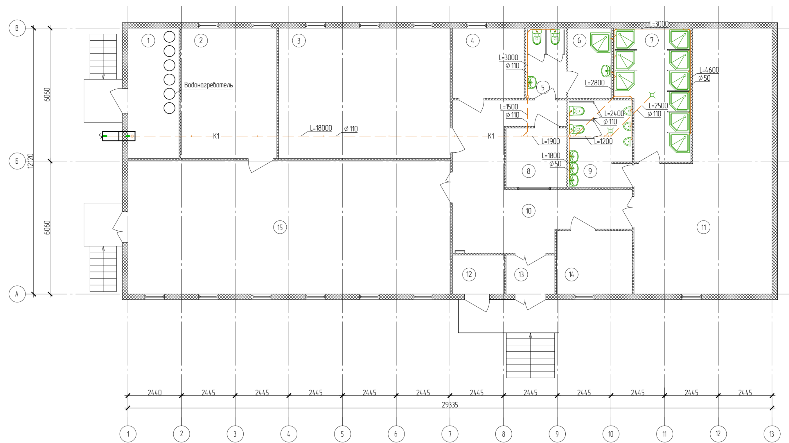
План системы водоотведения 1-го этажа
