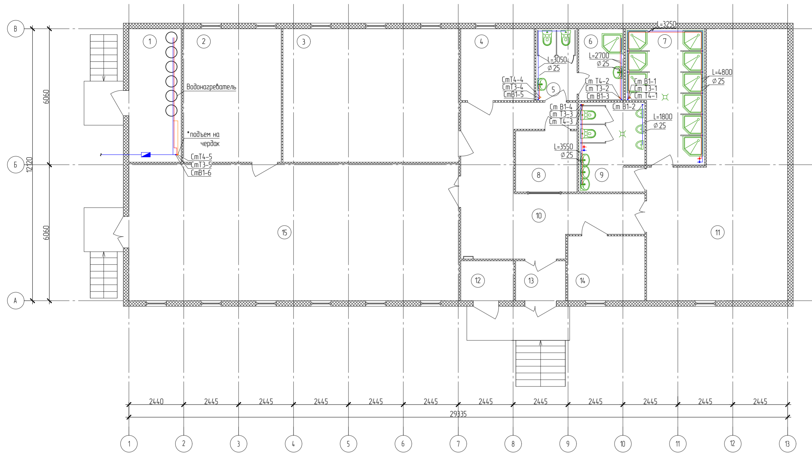
План системы водоснабжения 1-го этажа
