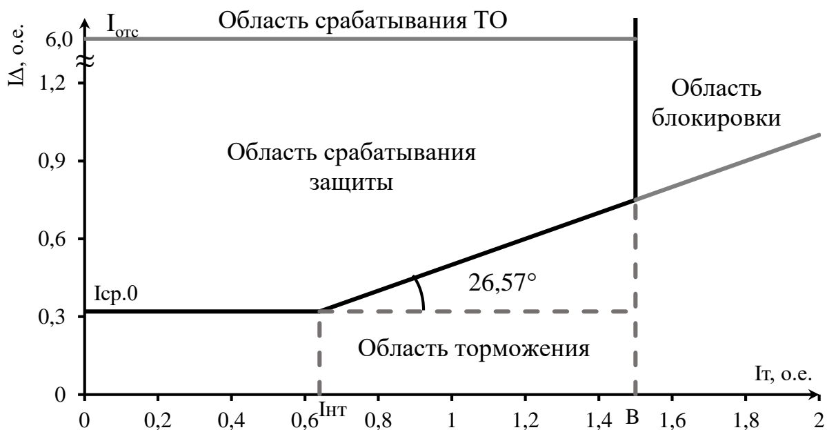
Рисунок 5.2 – Характеристика срабатывания продольной дифференциальной защиты генератора
