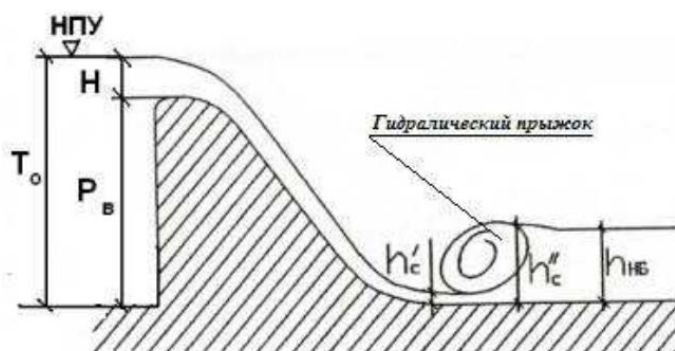
Рисунок 6.2 – Профиль водосливной плотины и сжатое сечение
