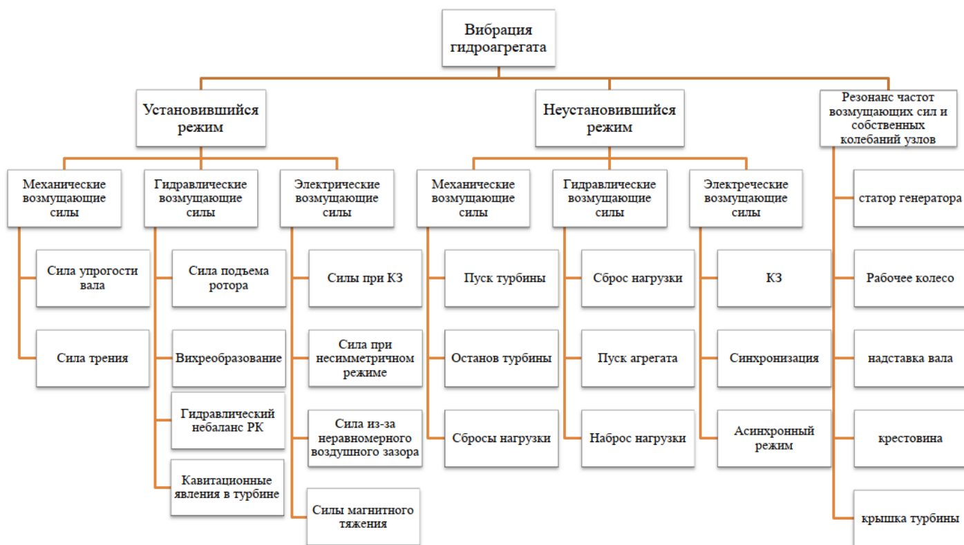
Рисунок 10.2 – Силы, вызывающие вибрацию гидроагрегата
