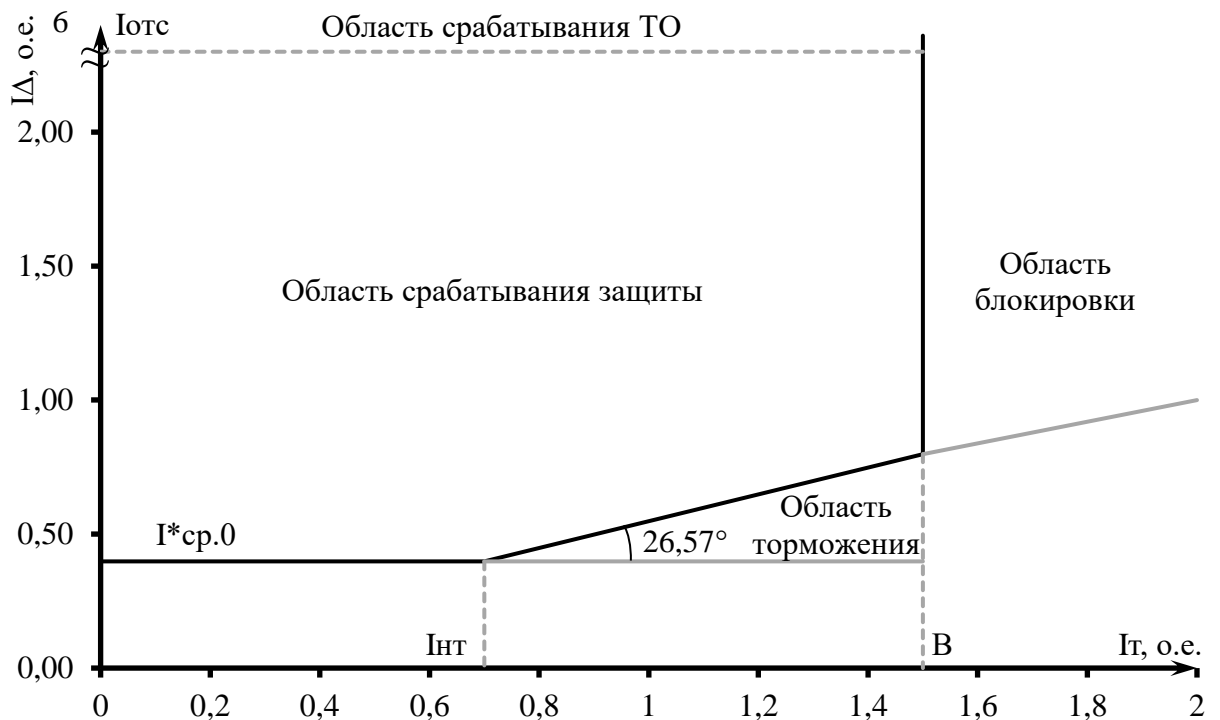
Рисунок 5.2 – Характеристика срабатывания дифференциальной защиты генератора
