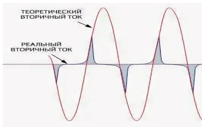
Рисунок 10.3 – Форма вторичного тока ТТ
