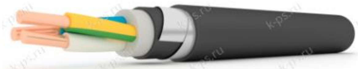
Рисунок 6.1 – Кабель ВВГнг(А)-LS (силовой кабель, с медной жилой, изоляцией и оболочкой из ПВХ пониженной пожарной опасности)
