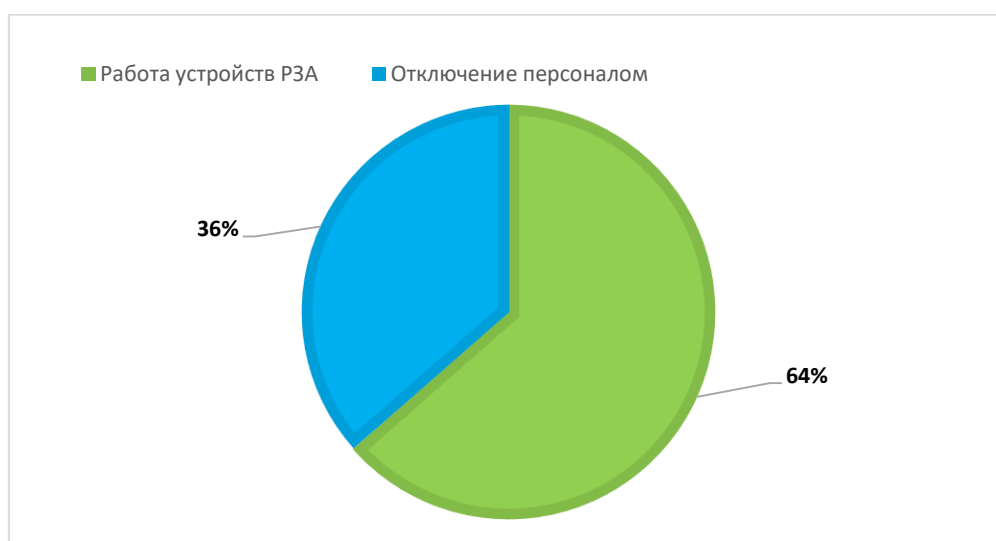
Рисунок 9 – Диаграмма долей времени простоя оборудования при авариях по фактору работы устройств РЗА или отключением персоналом
