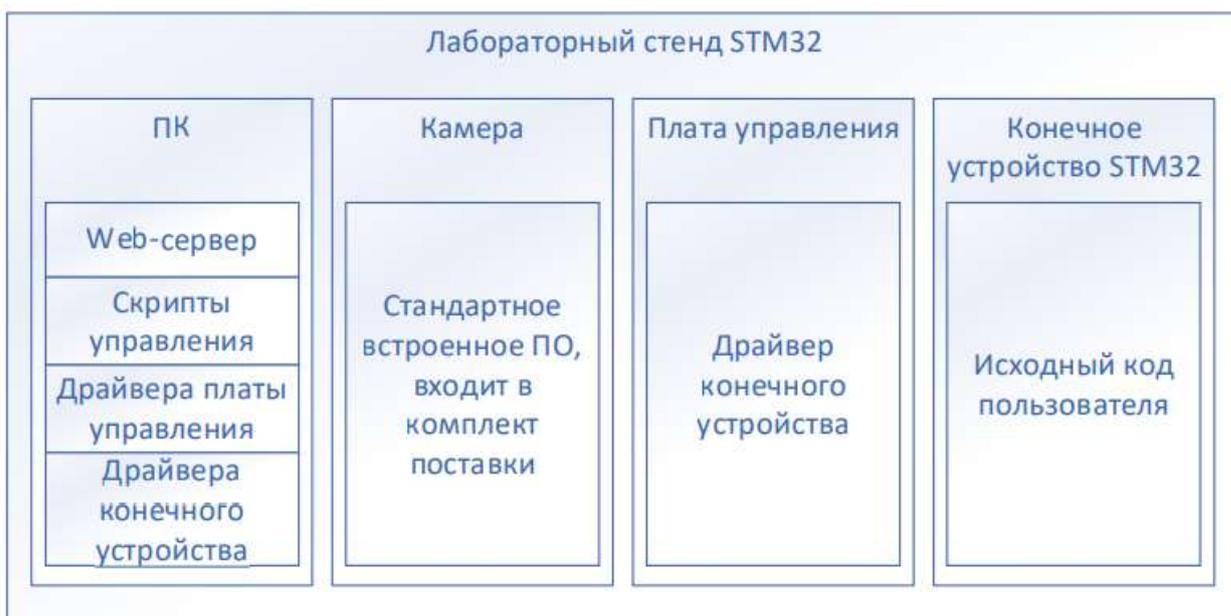
Рисунок 2 - Схема лабораторного стенда
