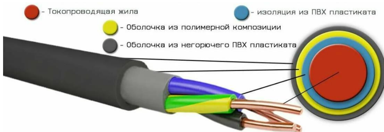
Рисунок 3.2 – Устройство кабелей ВВГнг(А)LS
