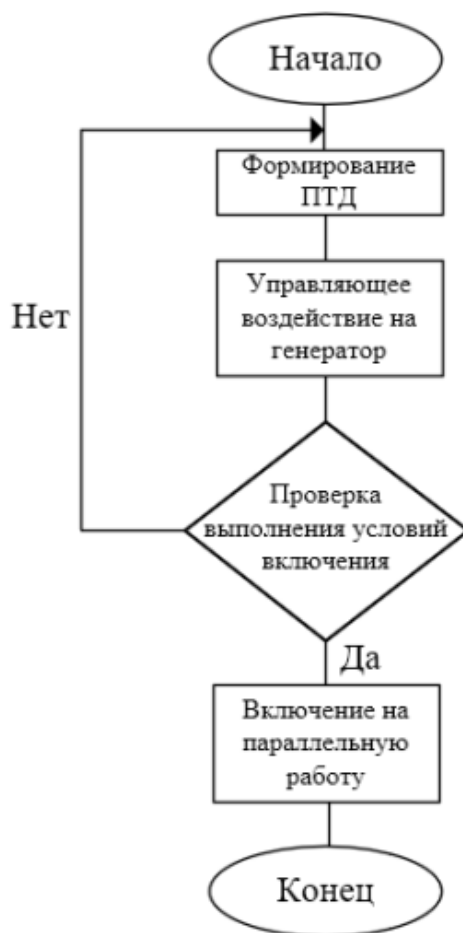
Рисунок 4 – Ход работы АПВ с контролем синхронизма
