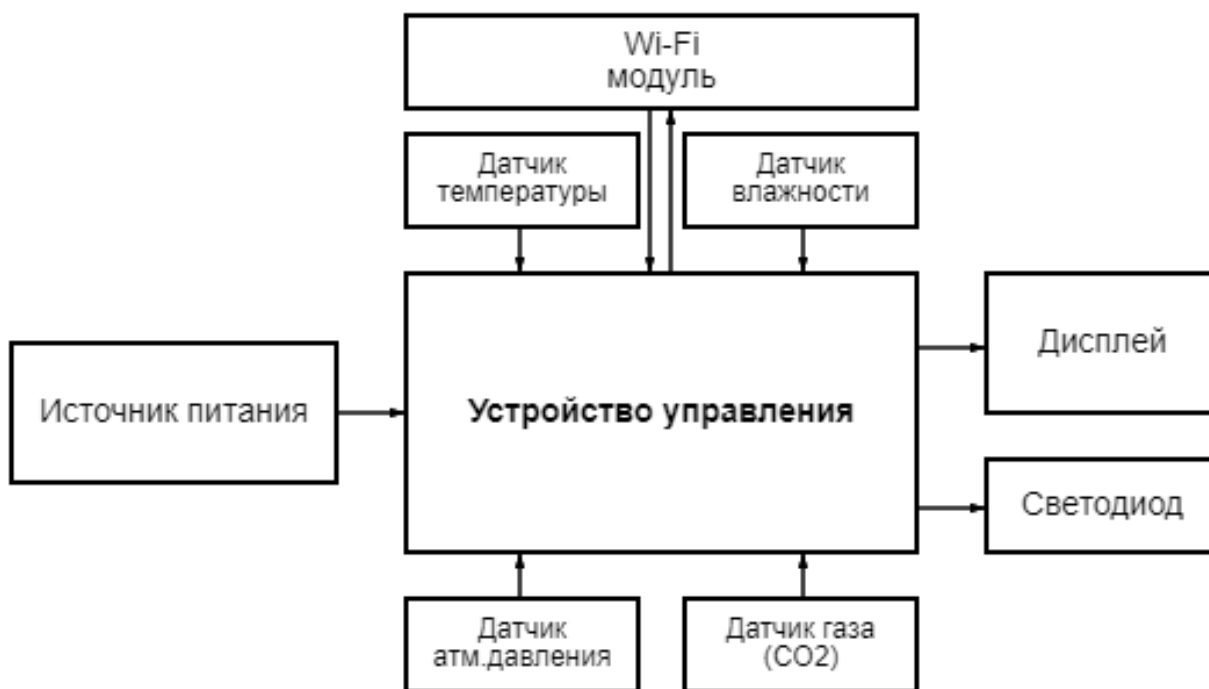
Рисунок 1 – Прототип структурной схемы системы
