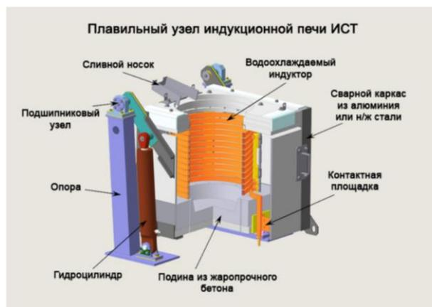
Рисунок 1.1 – Общий вид с разрезом ИТП [102].
