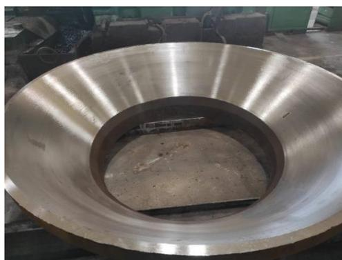
Рисунок 4.18 – Обработанная поверхность отливки.
