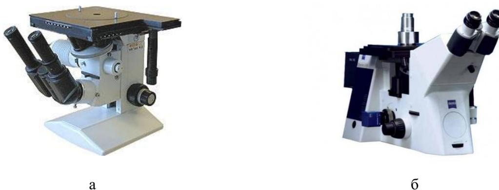
Рисунок 2.5 – Микроскоп Метам РВ-21 (а) [110] и Observer.A1m, Carl Zeiss (б) [111].
