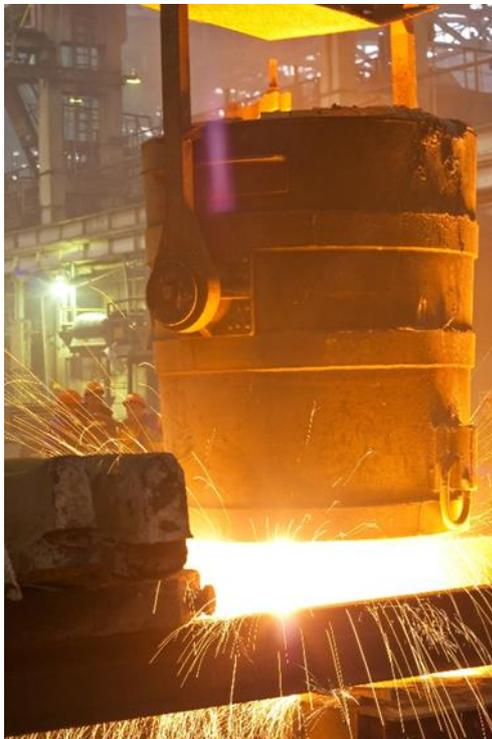
Рисунок 4.12 – Заливка литейной формы.
