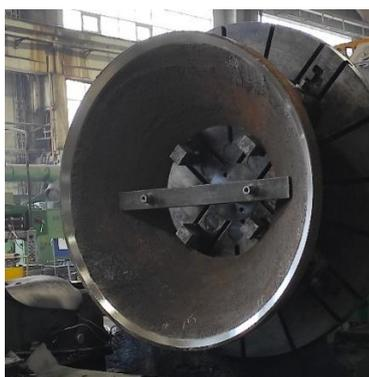
Рисунок 4.17 – Механическая обработка конусной брони на лоботокарном станке мод.1693.
