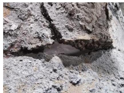
Рисунок 3.13 – Горячие трещины и обрыв монтажных петель конусной брони дробилки
