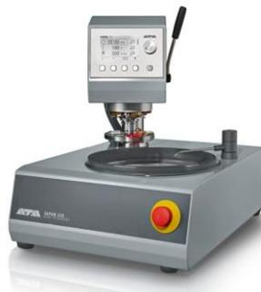
Рисунок 2.11 – Автоматический шлифовально-полировальный станок АТМ SAPHIR 520
