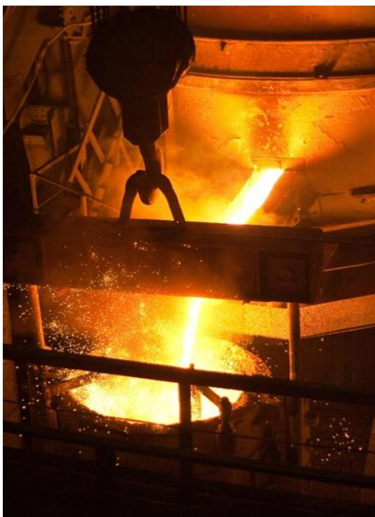
Рисунок 4.11 – Выпуск металла из электродуговой печи ДСП.
