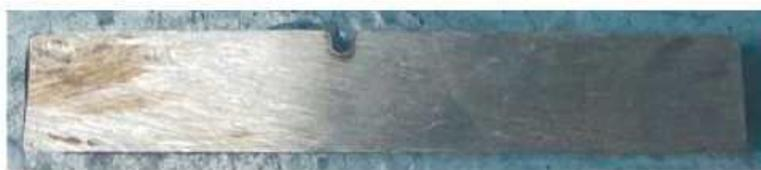
Рисунок 4.14 – Общий вид образца для определения ударной вязкости
