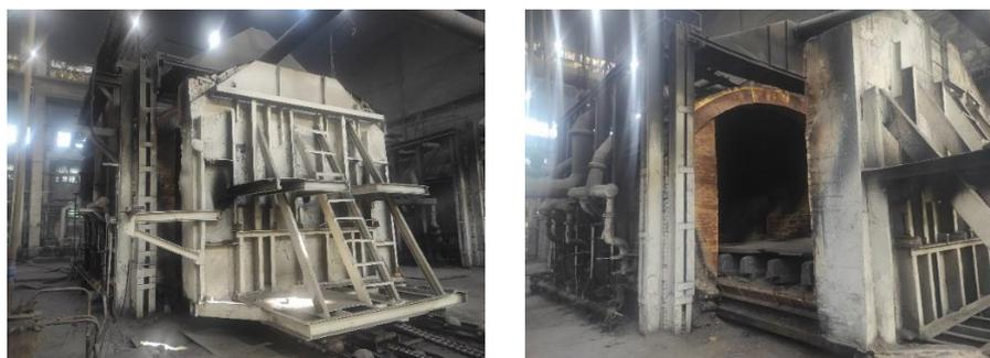
Рисунок 2.6 – Термическая печь с выкатным подом  $6\times 4$  метра
