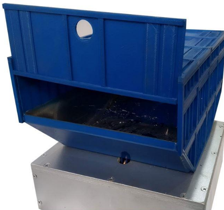
Рисунок 4.16 – Окно для заливки эвтектического сплава в модель печи
