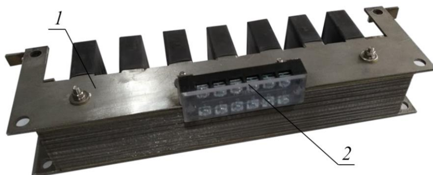
Рисунок 4.3 – Магнитопровод индуктора МГД-насоса в сборе
