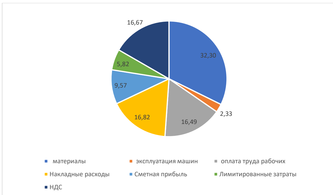
Рисунок 6.3 – Анализ структуры локального сметного расчёта на работы по возведению монолитного железобетонного каркаса по составным элементам
