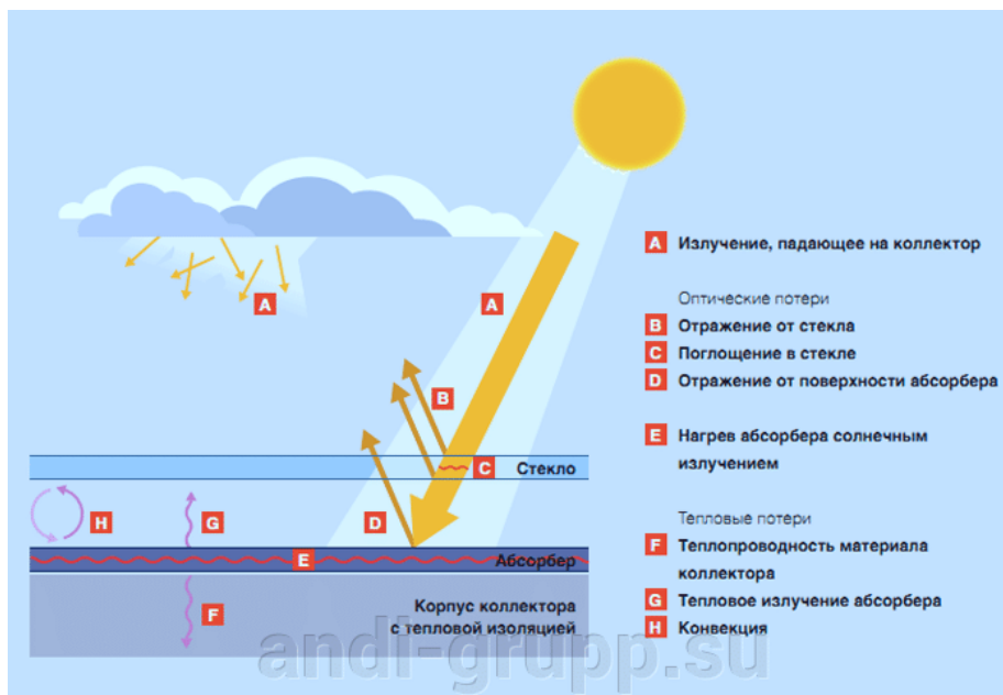
Рисунок 5 – Тепловые потери в солнечном коллекторе
