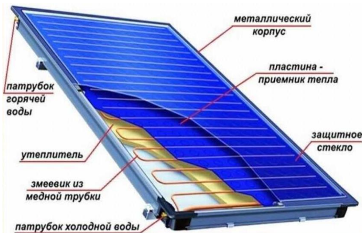
Рисунок 6 –Конструкция солнечного коллектора
