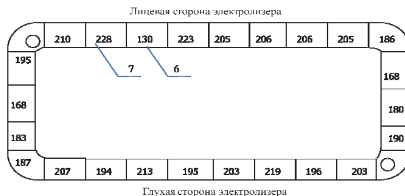
Рисунок 10 - Температура поверхностей газосборного колокола электролизера, с учетом установки теплоизоляционного слоя на сектор №6
