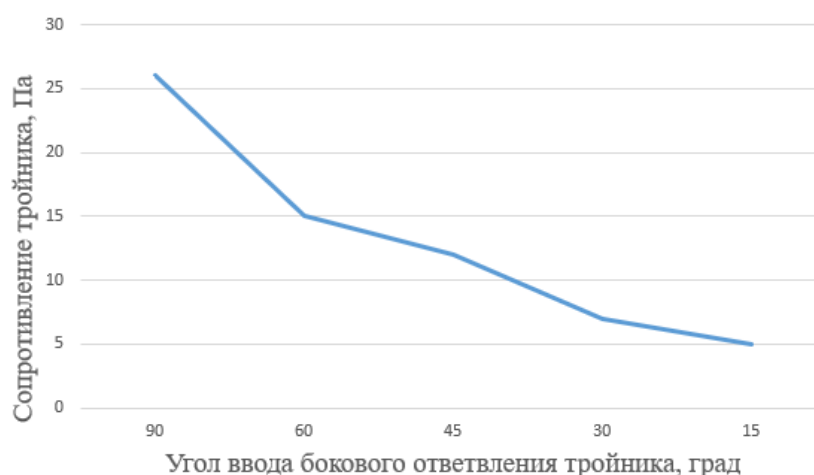
Рисунок 12 – Визуальное отображение изменений сопротивления тройника при различных углах ввода бокового ответвления и соблюдении условия F_{\Pi} + F_{\Gamma} = F_{\Sigma}
