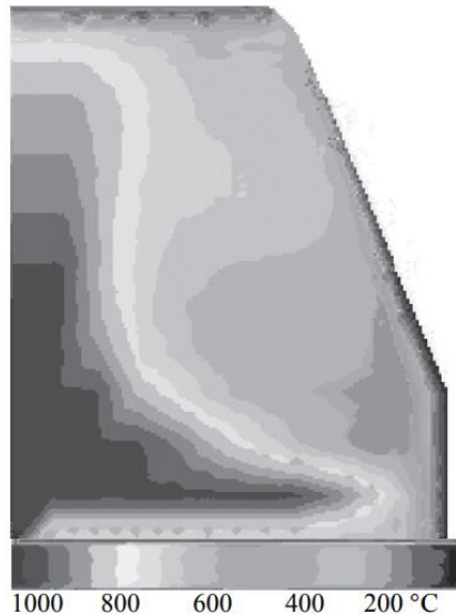
Рисунок 9 – Поле температур в поперечном сечении подколокольного пространства
