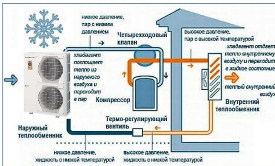
Рисунок 1.3 – схема работы теплового насоса «воздух-воздух»
