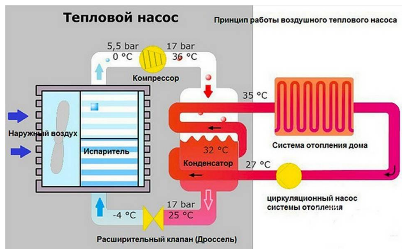
Рисунок 1.5 – принцип работы «воздух-вода»
