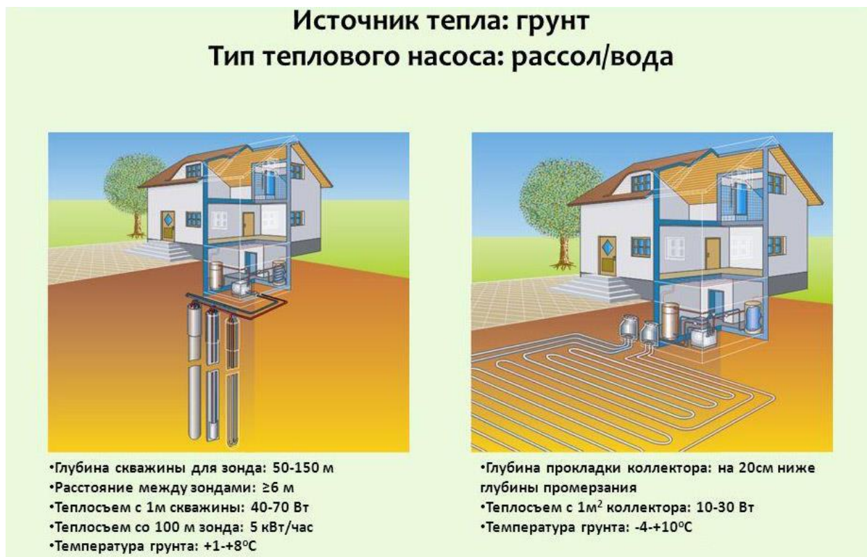
Рисунок 1.6 – Принцип размещения теплообменника «грунт-вода»
