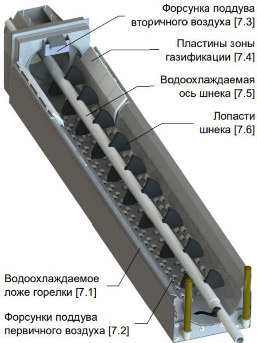
Рисунок 7 – Линейная (канально-шнековая) горелка Терморобот
