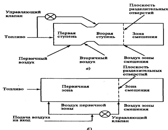
Рисунок 3.1 – Камеры сгорания: а – многоступенчатая по топливу;
