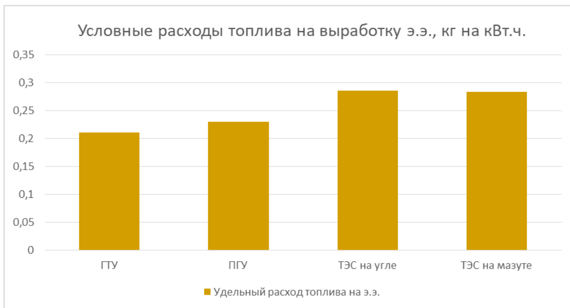
Рисунок 1.1 – Удельные расходы условного топлива на выработку 1 кВт/ч для разных типов ТЭС
