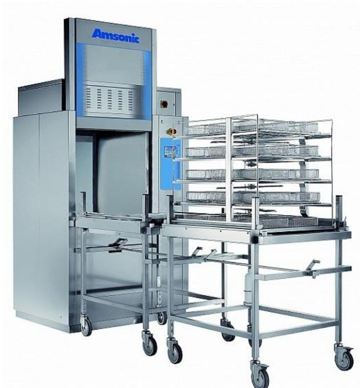
Рисунок 3.7 - Моечная машина Amsonic AquaJet21
