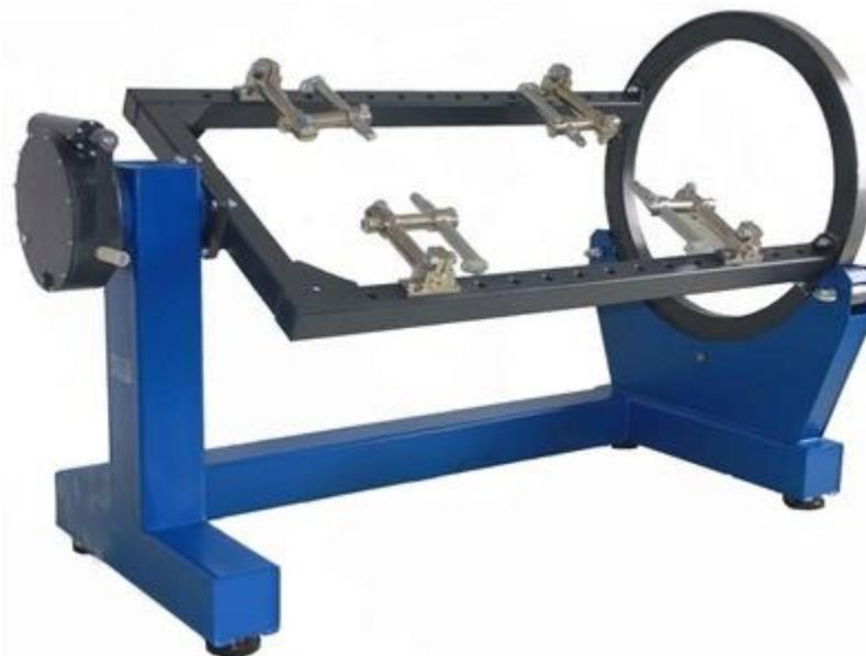
Рисунок 3.11 - Стенд для разборки-сборки двигателей (ручной) P-776E
