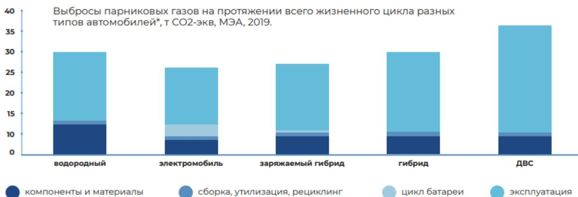
Рисунок 1.1 – Выбросы на протяжении жизненного цикла
