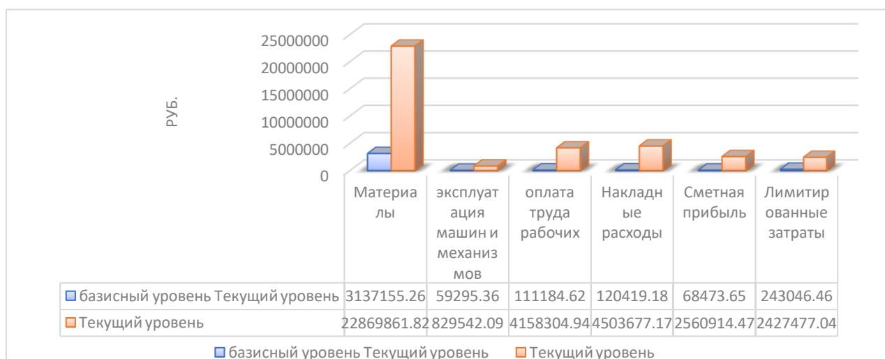
Рисунок 6,3 – Структура локального сметного расчета на монтаж железобетонного каркаса по составным элементам в виде гистограммы
