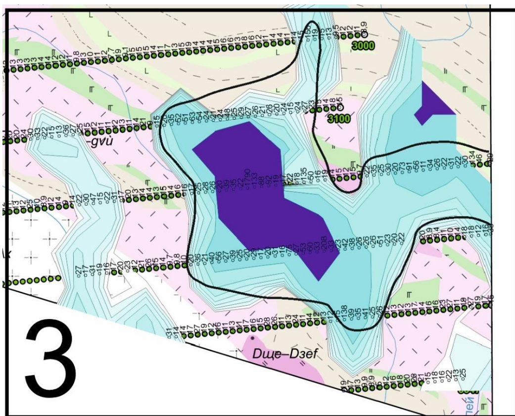
Рисунок 5.17 – Контур геохимической аномалии цинка по уровню C_{a9} = 19 \text{ г/т} в пределах перспективного участка «3»
