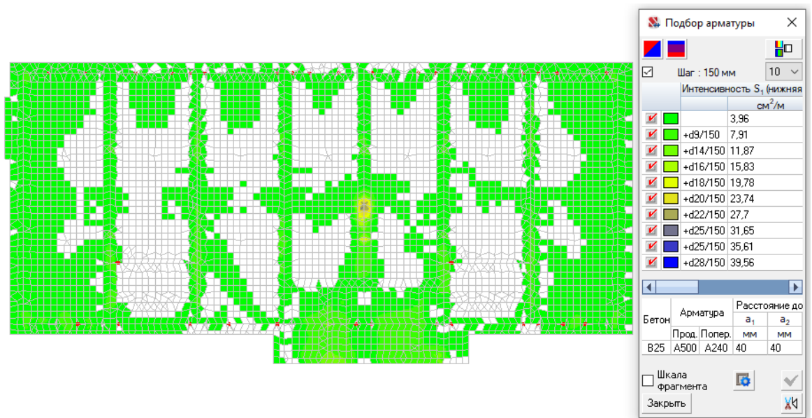
Рисунок 3.21 – Дополнительное нижнее армирование по X (шаг 150 мм)
