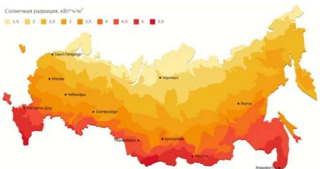
Рисунок 9 – Карта интенсивности удельной суточной дозы солнечного излучения
