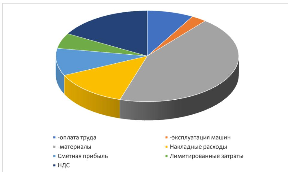
Рисунок 6.1 – Диаграмма локального сметного расчета на строительные работы по составным элементам
