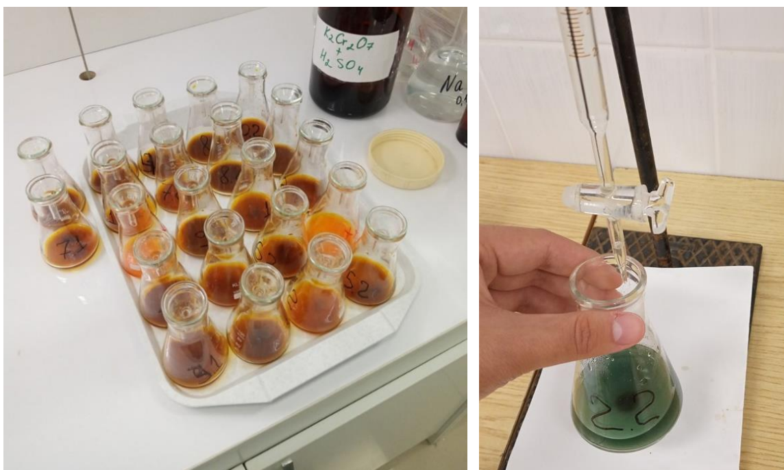
Рисунок 13 – Растворы после добавления фенилантраниловой кислоты (слева) и титрование 0,2 н раствором соли Мора (справа)
