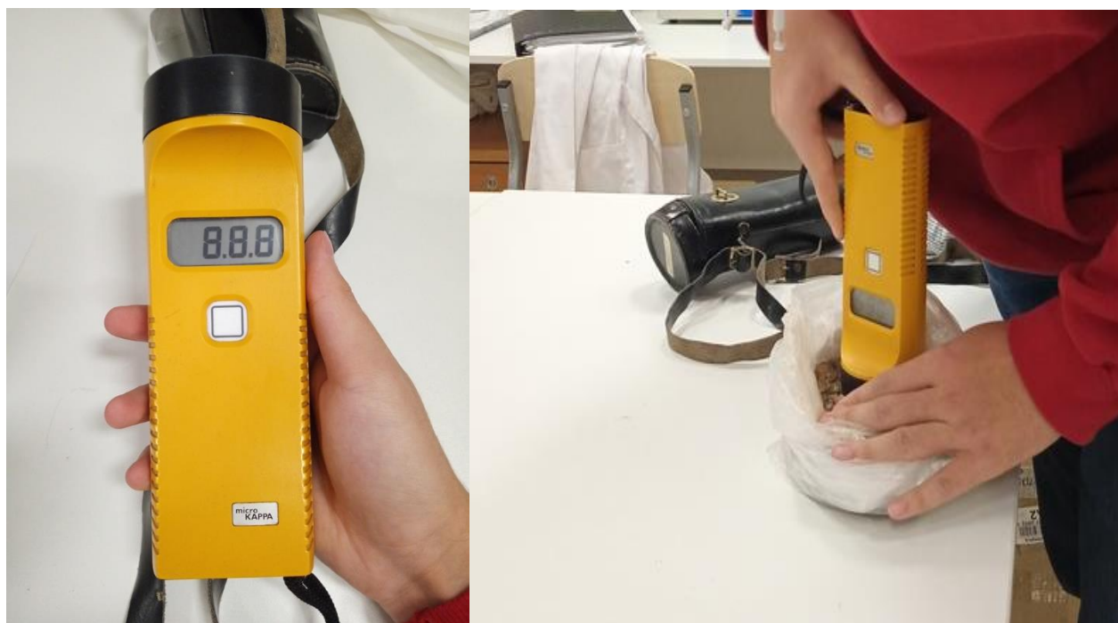
Рисунок 20 – Каппаметр КТ-5 и измерение магнитной восприимчивости
