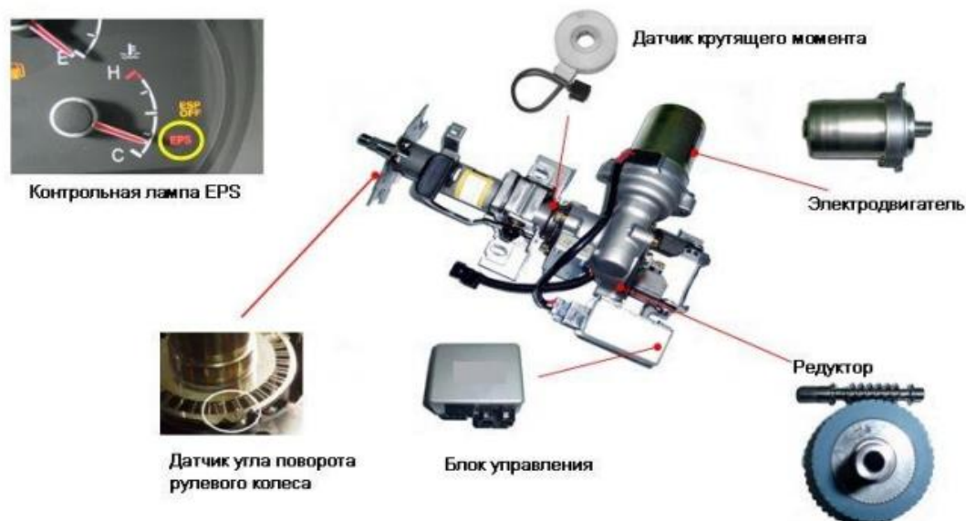
Рисунок 2.6 – Состав системы электроусилителя
