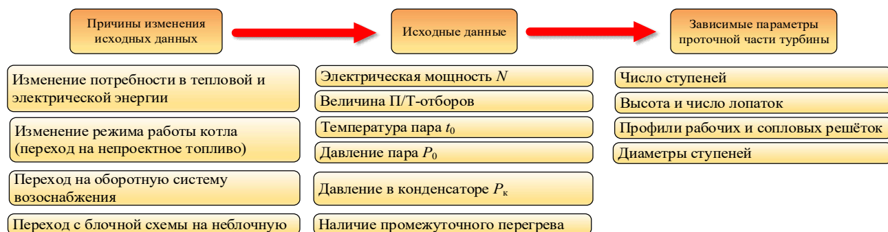
Рисунок 8 – Влияние внешних факторов на исходные данные при расчёте паровых турбин
