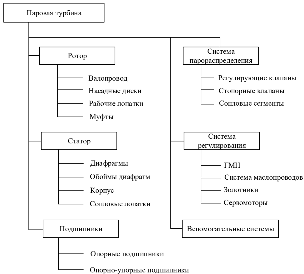
Рисунок 3 – Укрупнённый элементный состав паровой турбины
