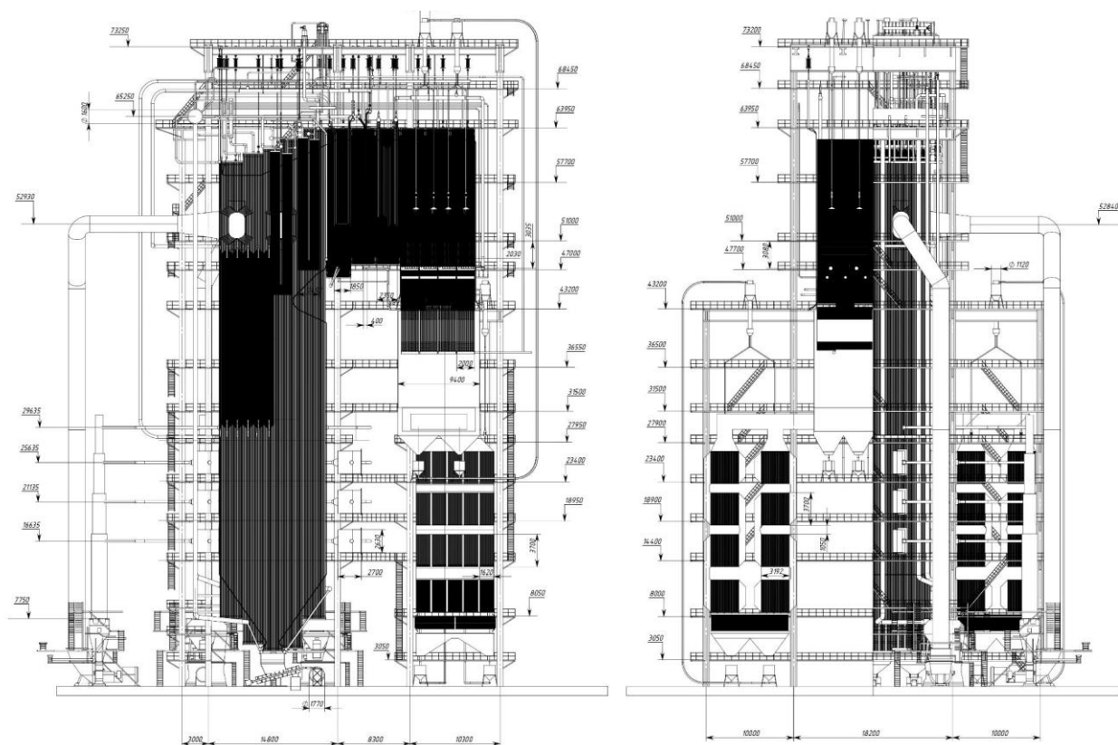
Рисунок 4 – Продольный и поперечный разрез котла ТПЕ-216
