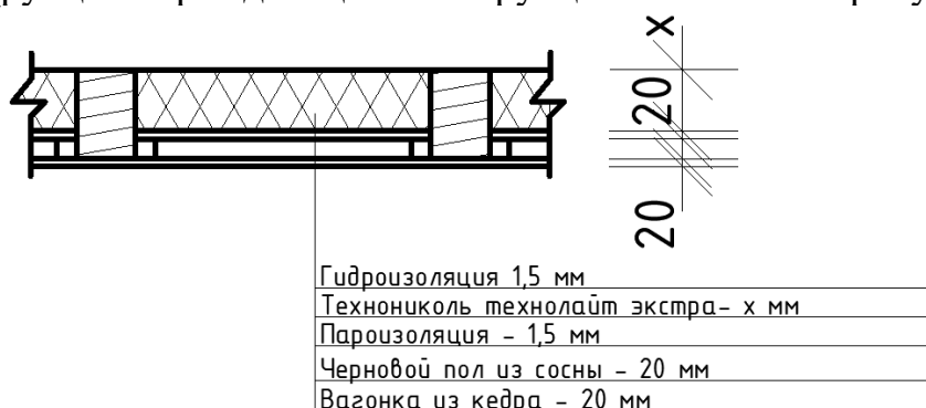
Рисунок 1.4 - Разрез чердачного перекрытия
