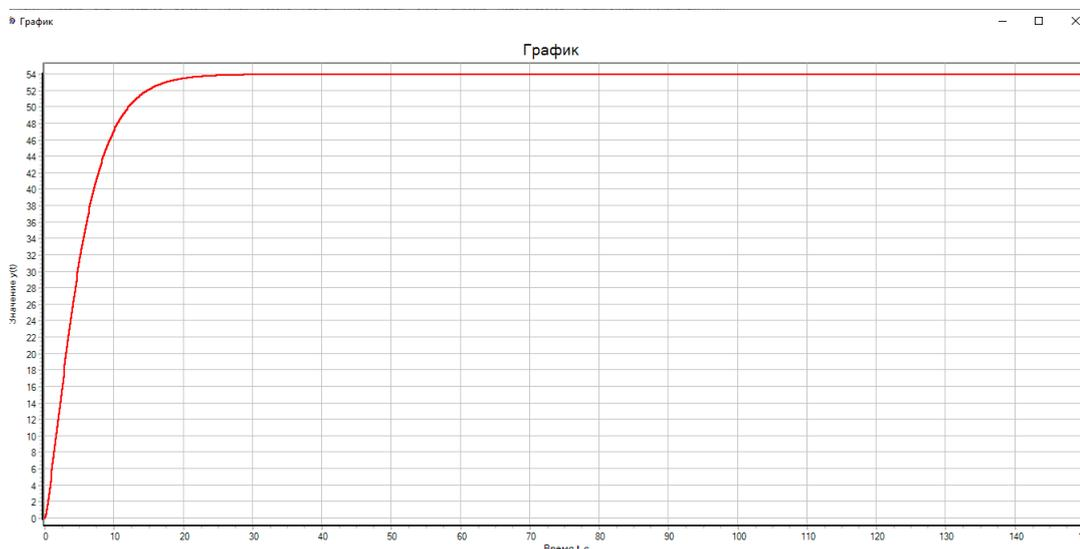
Рисунок 15 – График переходного процесса привода с настроенными коэффициентами ПИД- регулятора
