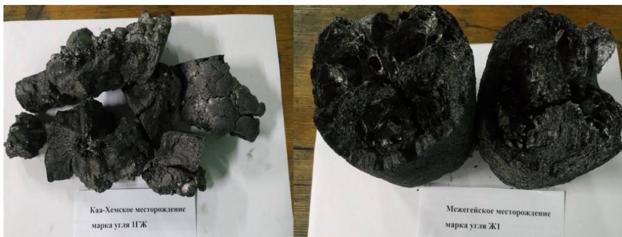
Рисунок 13. Внешний вид углеродного материала из углей марок ГЖ и Ж1.
