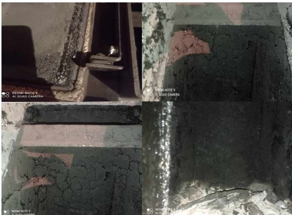
Рисунок 20 – Осаждение углерода и смолистых веществ на внутренних стенках из летучих веществ при сжигании угля ГЖ в котле «Неделька» КО-90.
