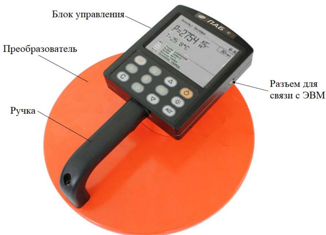
Рисунок 1.1 – Внешний вид прибора ПАБ [24]
