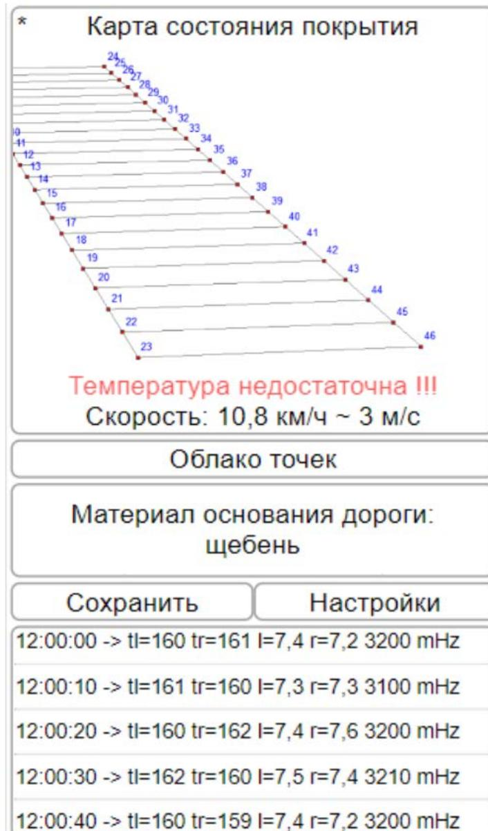
Рисунок 4.8 – Двумерная карта состояния покрытия
