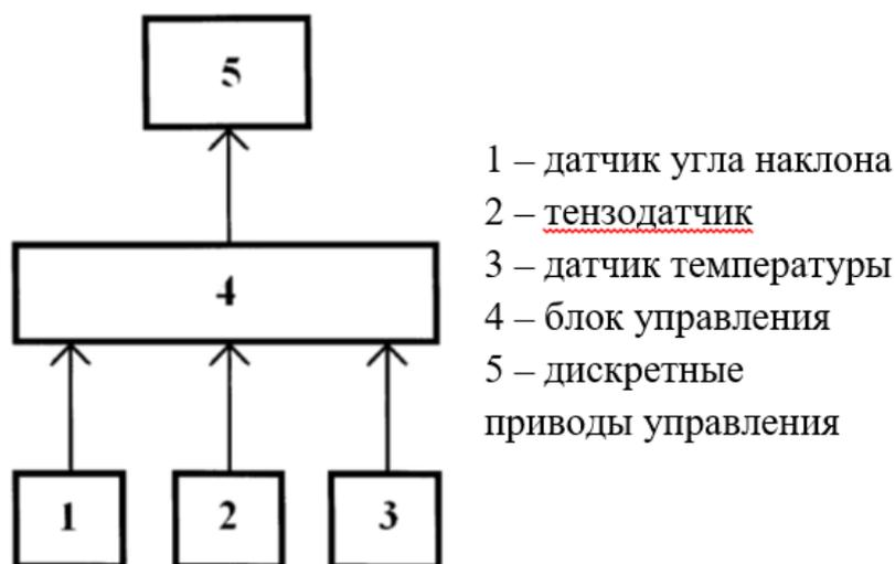
Рисунок 1.23 – Система автоматического управления дорожного катка [29]
