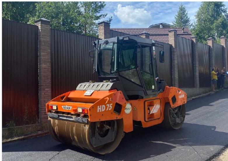
Рисунок 13 – Общий вид вибрационного катка НАММ HD 75
