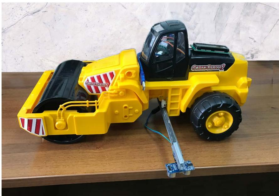
Рисунок 3.1 – Модель дорожного катка с аппаратно-программной системой контроля на платформе Arduino
