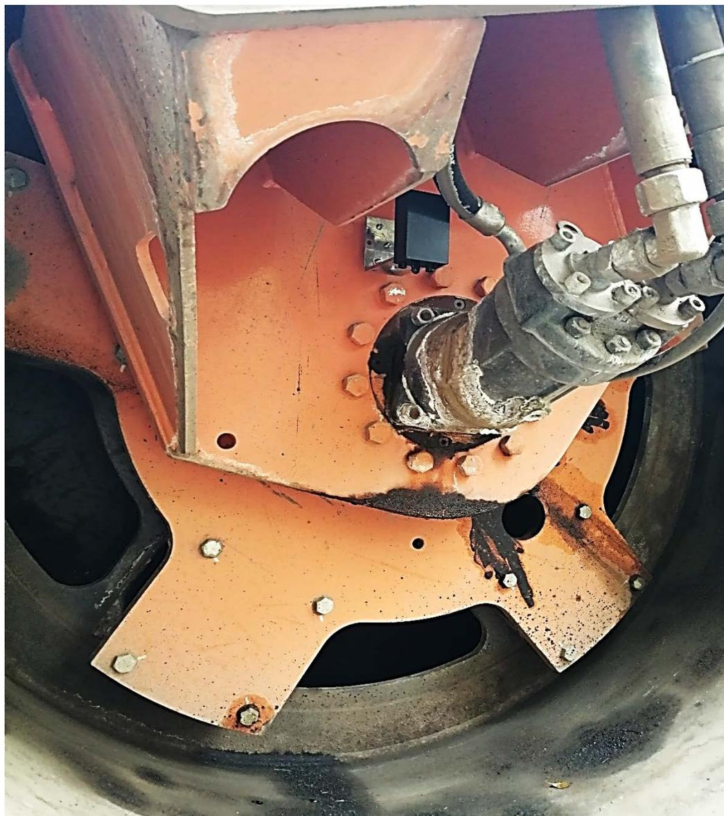
Рисунок 3.15 – Установка акселерометра на валец катка
