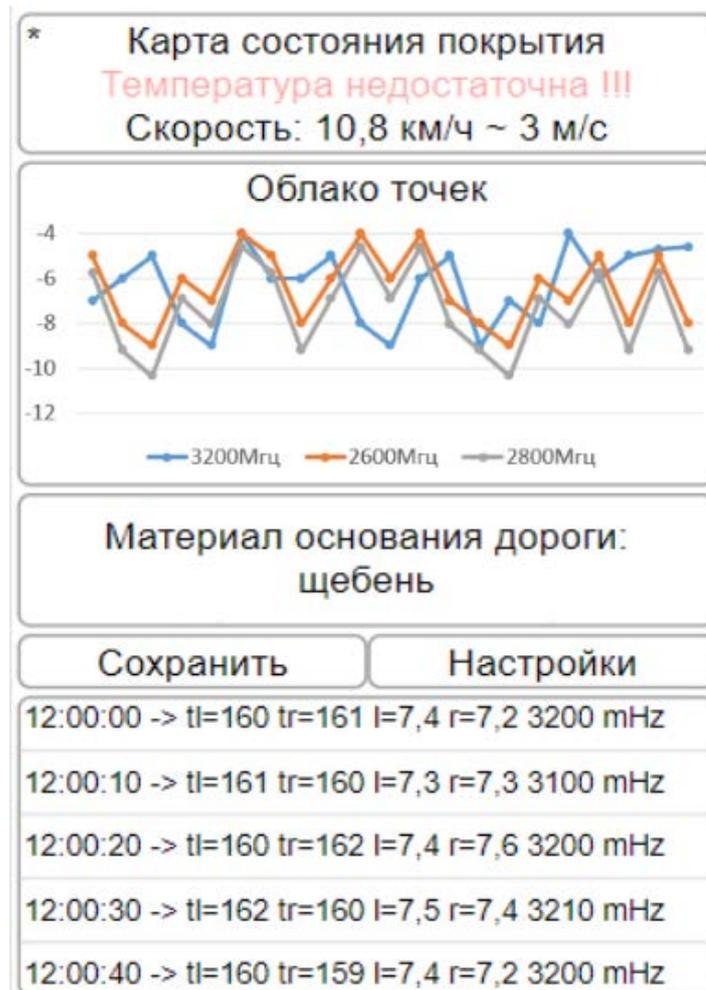
Рисунок 4.9 – Отображение облака точек поверхности дорожного полотна
