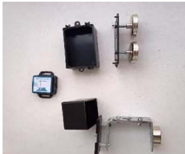
Рисунок 3 – Датчик акселерометр ADXL345 с корпусом и магнитом
