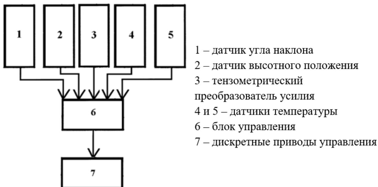
Рисунок 1.22 – Система автоматического управления винтового шнека асфальтоукладчика [28]
