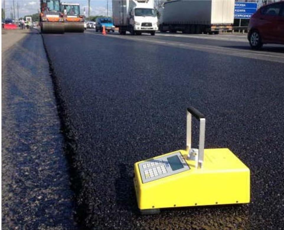
Рисунок 1.3 – Прибор радиометрического контроля плотности асфальтобетона
