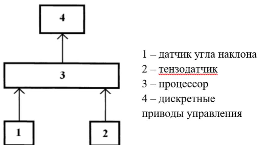
Рисунок 1.21 – Система автоматического управления процессом уплотнения асфальтобетонной смеси катком [27]
